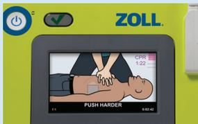
A tecnologia Real CPR Help<sup>®</sup> proporciona feedback em tempo real sobre aprofundidade e frequência das compressões torácicas, ajudando o socorrista a realizar RCP de alta qualidade.
